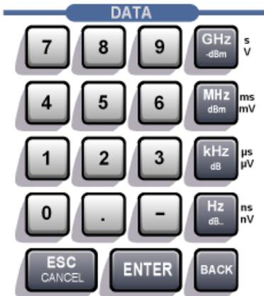
Der Ziffernblock dient der Eingabe von numerischen Parametern. Er enthält die Tasten:
