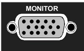
Nach dem Anschluss des externen Monitors muss das Gerät neu gestartet werden, um den Monitor zu erkennen. Anschließend wird der Messbildschirm sowohl am externen Bildschirm wie auch am Gerät angezeigt. Weitere Einstellungen sind nicht erforderlich.
