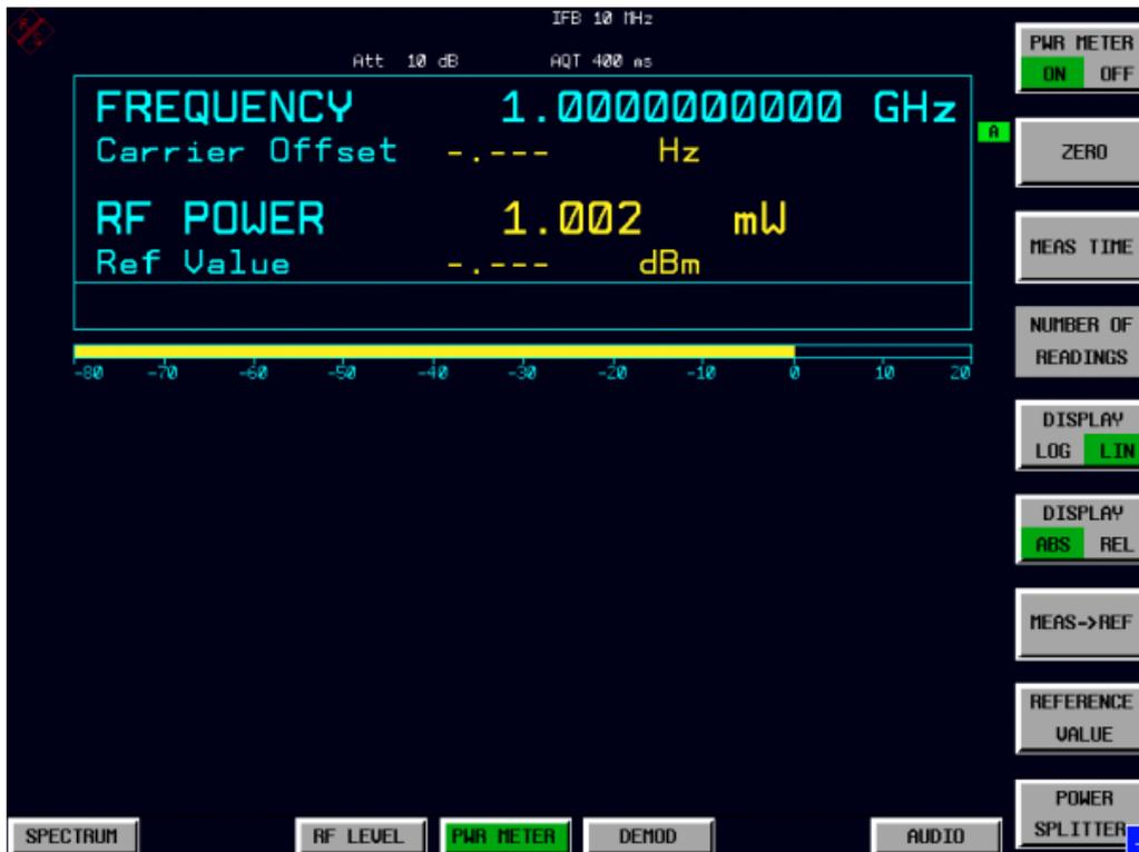
Bild 5-4 HF-Leistungsmessung in Watt
