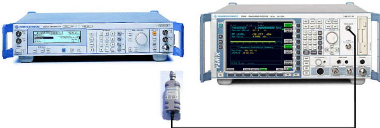
Bild 5-2 Aufbau für HF-Leistungsmessung
