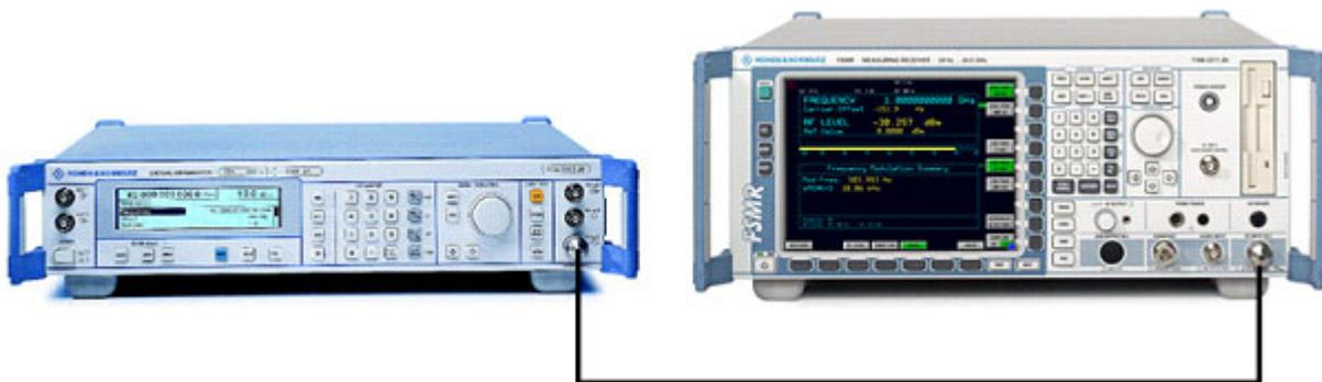
Bild 5-9 Aufbau für AM-Modulationsmessung
